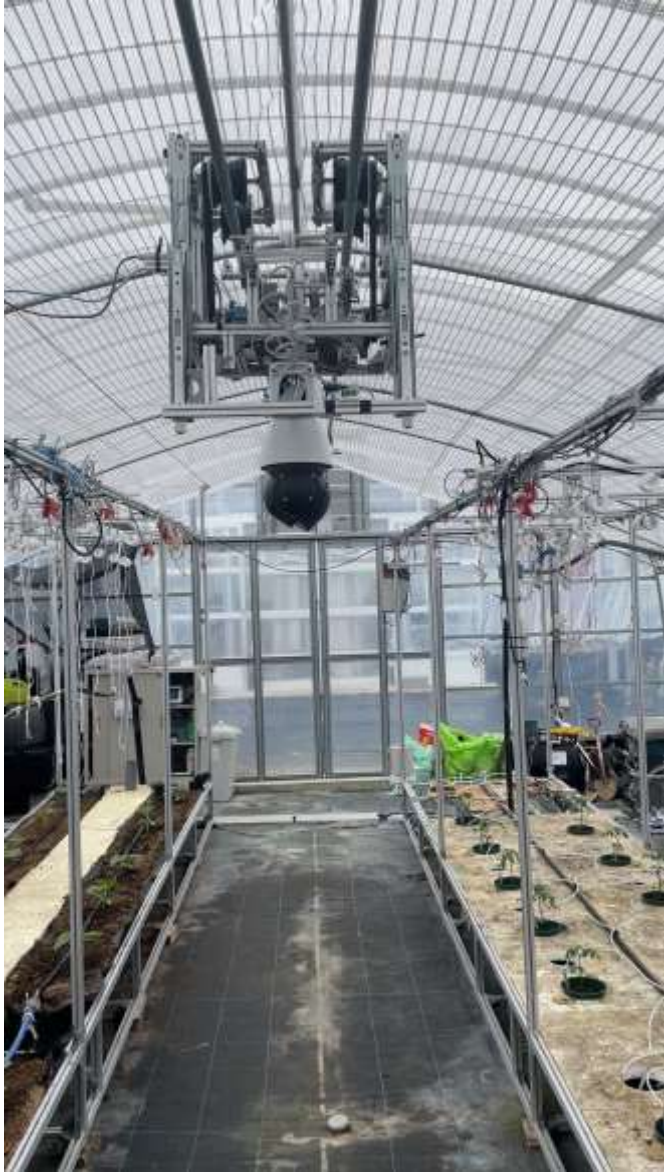
計測ロボットの移動の様子
